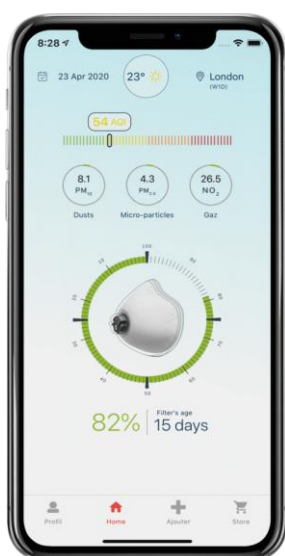
Fig 29 Sur son Smartphone, l'utilisateur du masque prend connaissance de l'autonomie restante de filtrage avant saturation du filtre. Crédit photo R-PUR reproduction autorisée.
